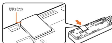
3 au Micro IC Card (LTE) が奥まで挿入されていることを確認してから、背面カバーの矢印方向にスライドして取り付ける
